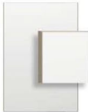
Form hvid eg 16 mm plade belagt med 120 g melamin. Kantet med 3,2 mm massiv træliste.
